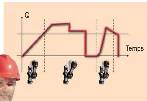
Le déplacement proportionnel de la commande est parfaitement restitué par la pompe.
