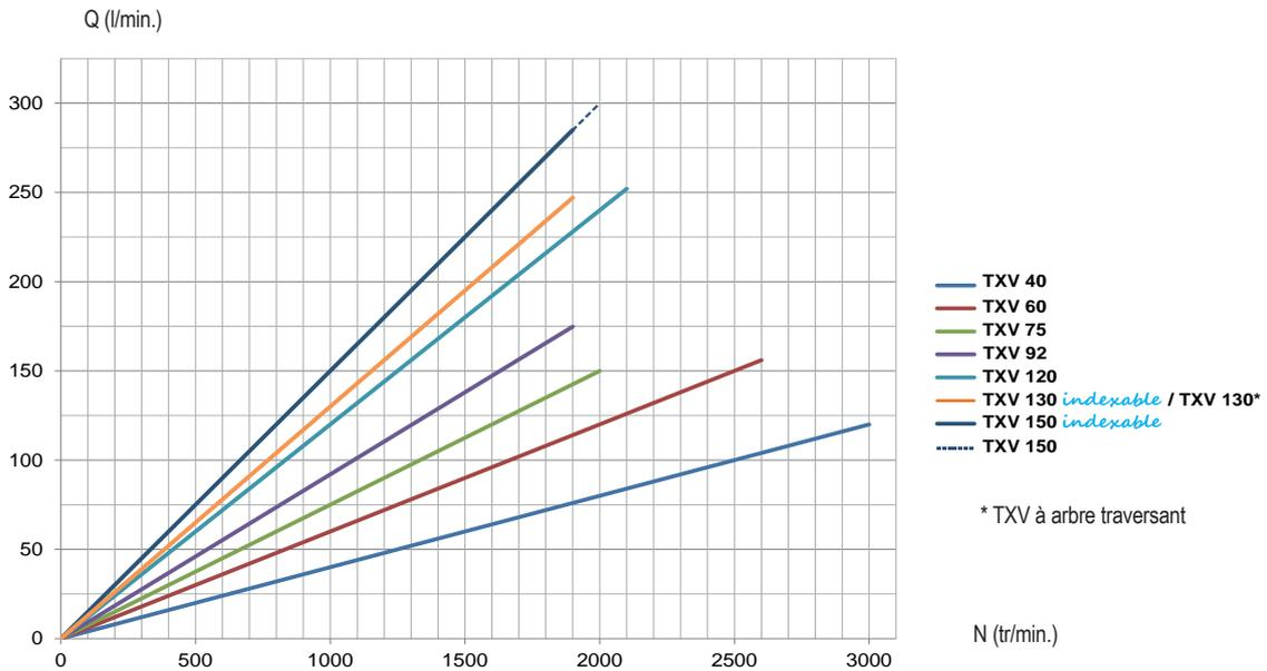
Débit en fonction de la vitesse, de la cylindrée maximale de la pompe, pour une alimentation en charge.
